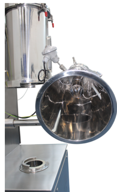
Détail du tube de Wurster installé dans la trémie du produit, en position de déchargement.
