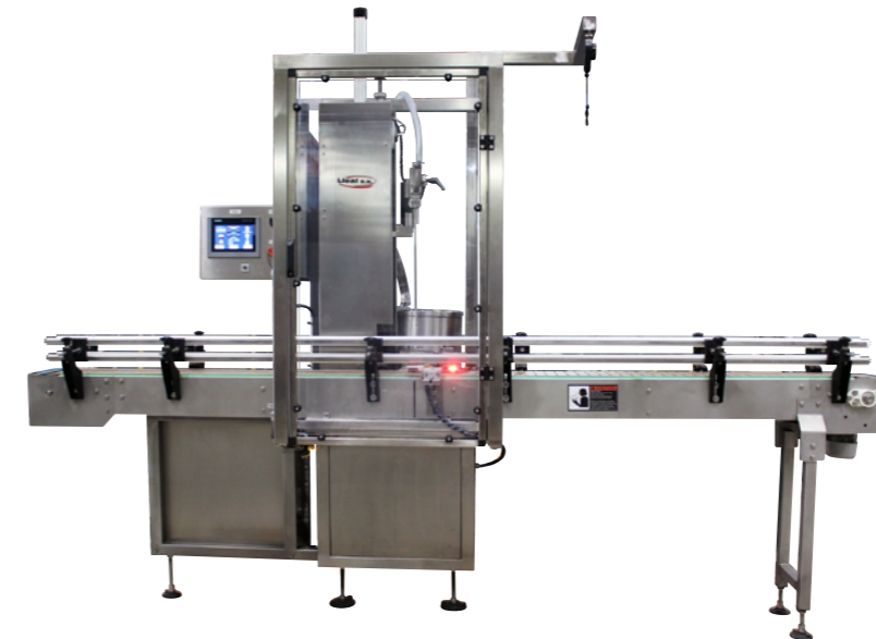
Remplisseuse STAR équipée d'une bande de transport pour les récipients et d'un carénage de protection dans la zone d'emballage en méthacrylate.
