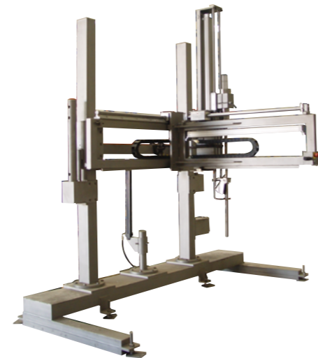
Remplisseuse PEN-2000-C entièrement en acier inoxydable avec système de transfert cartésien.
