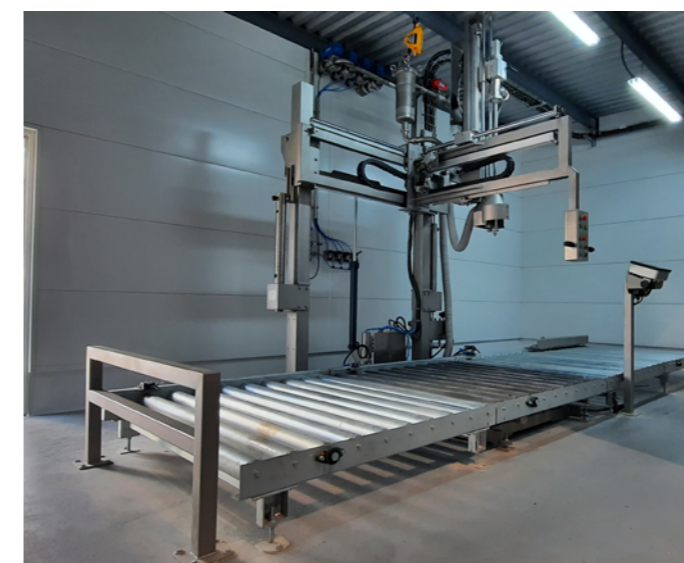
Remplisseuse PEN-2000-C équipée d'un chemin à rouleaux motorisés pour l'entrée et la sortie des emballages.
