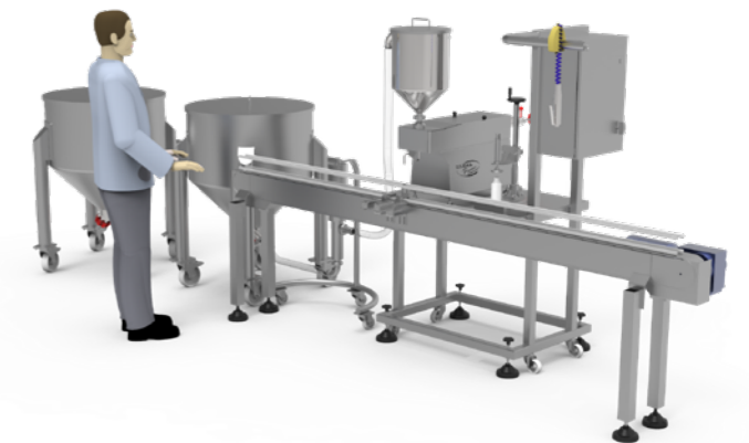
Image 3D d'un système d'emballage composé d'une Dosifix avec station de fermeture à vis et bande transporteuse.
