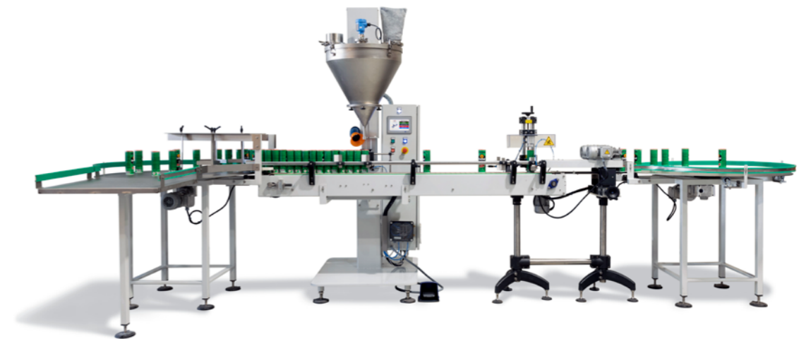
Ligne de conditionnement de poudre en boîtes, en dynamique et avec contrôle du dosage volumétrique, équipée d'une table rotative pour l'alimentation des conteneurs et d'une table de collecte en fin de ligne.
