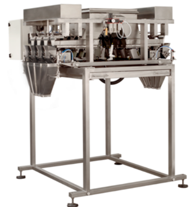
Peseuse linéaire prête à être installée sur thermoformeuse ou transporteur à bande.
