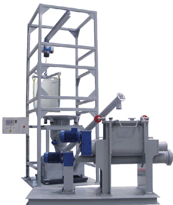
Déchargeur de big-bags avec palan électrique de 1 500 kg, alimentant un malaxeur extrudeur AME-300.
