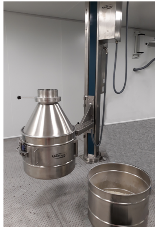
Élévateur à colonne ECLL-200 pour BINS avec système de palan à chaîne, préparé pour une charge maximale de 200 kg
