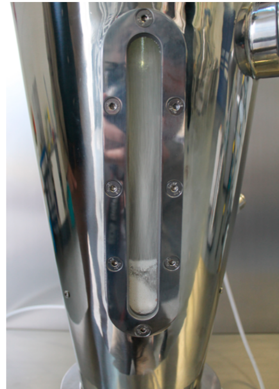
Détail de la trémie du produit. La fenêtre d'observation permet de voir le produit en cours de fluidification.
