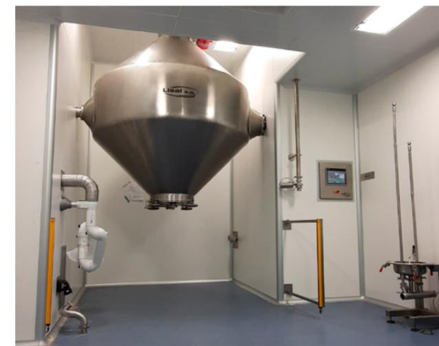
Sécheur SBC-4200 en salle propre.
