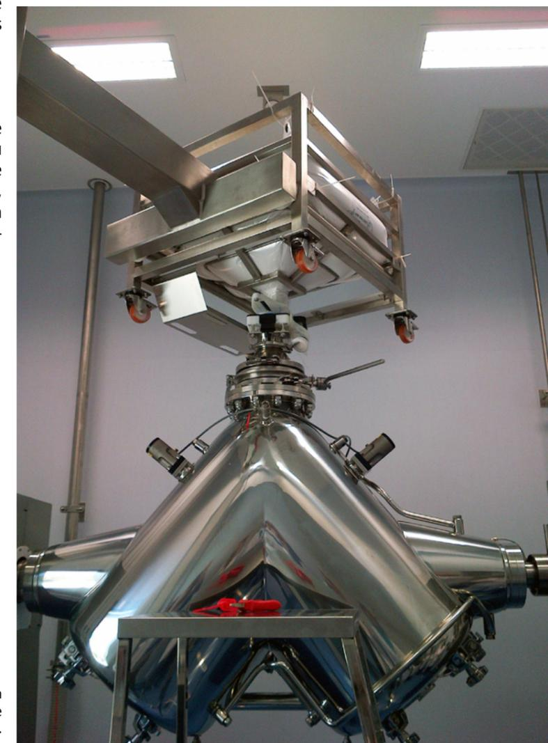
Processeur PB-250-CAIVR en position passive, alimenté par un élévateur de conteneurs.
