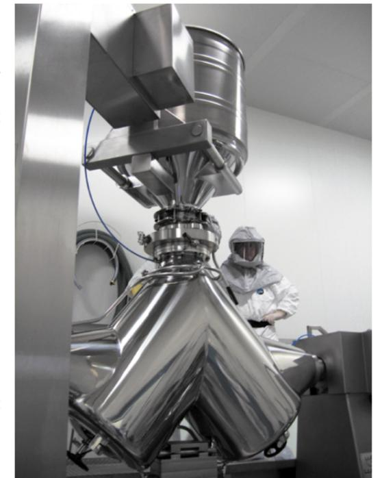
Processeur PB-250-CAIVR en position de charge, équipé d'une vanne active/passive.
