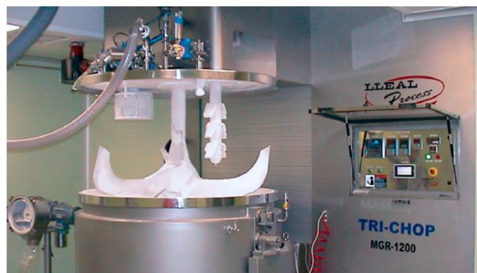
Vue d'un TRI-CHOP MGR-1200 avec banc intégré, installé en salle blanche de l'entreprise pharmaceutique.
