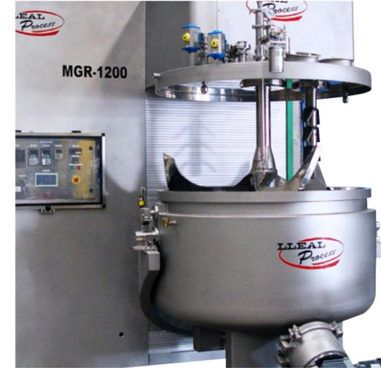
**LE COUVERCLE :** monté en position fixe, il est prêt à réaliser une excellente étanchéité au vide, assurée par la pression exercée par le système hydraulique de levage de la cuve. Il dispose de différents accessoires qui permettent : introduction de solides ; admission de liquides de granulation ; connexion et contrôle sous vide ; et visualisation du processus par un point lumineux avec une lampe halogène.
