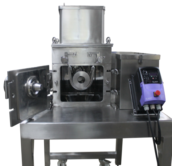
Vue de l'intérieur d'un granulateur MG.
