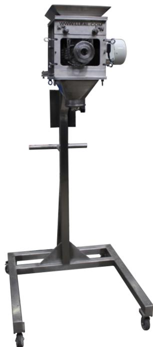
Détail de la vis sans fin installée dans la trémie d'alimentation. Tête relevable de façon hydraulique.
