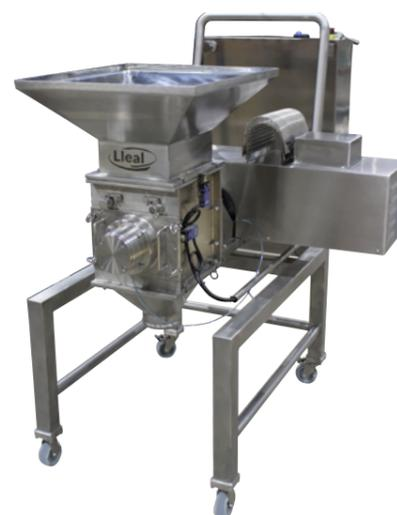
Granulateur rotatif CT-150 *pharma*, installé sur un chariot mobile
