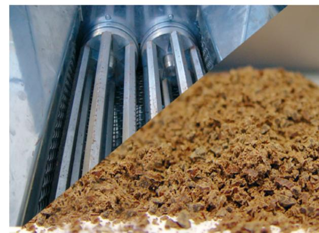
Détail des rouleaux granulateurs d'un CT-400 avec maille en bas et détail du produit obtenu.
