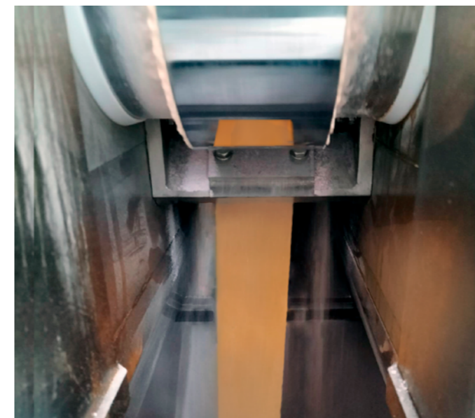
Image d'une feuille de produit à la sortie du groupe de compactage.
