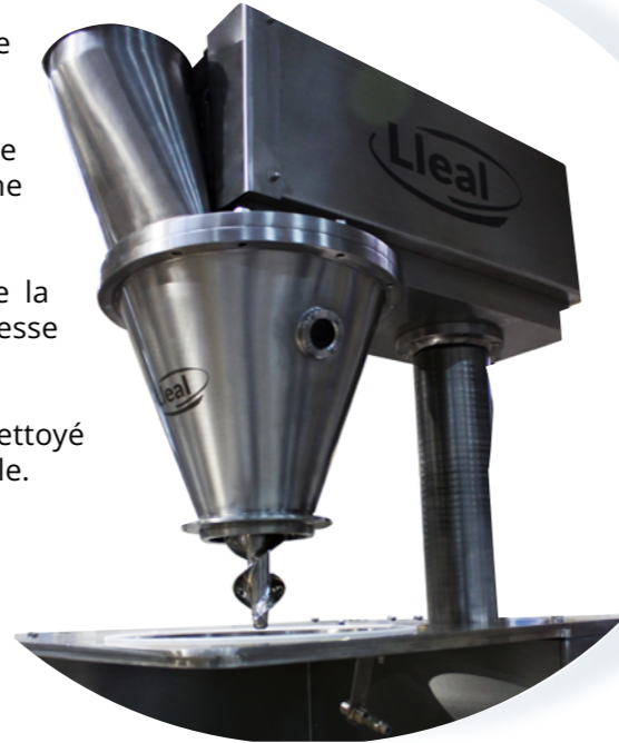
Détail de la vis sans fin installée dans la trémie d'alimentation. Tête relevable de façon hydraulique.
