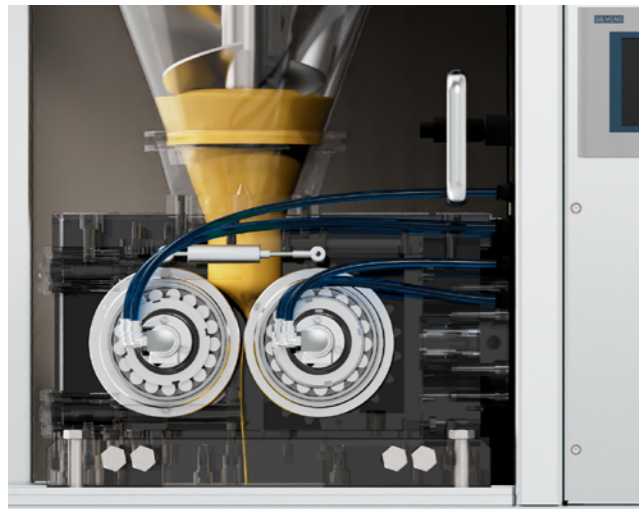
Détail des rouleaux de compactage.
