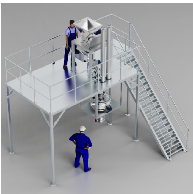
Installation en cascade composée d'un Broyeur ST-315, un broyeur Komodin et un tamis vibrant.
