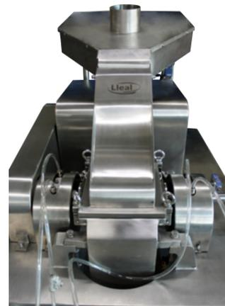
Système d'alimentation prêt à être connecté au transport pneumatique.
