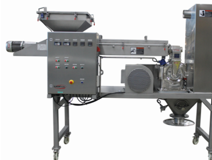
Installation de broyeur cryogénique K-160 pharma, équipé d'un filtre à manche automatique.
