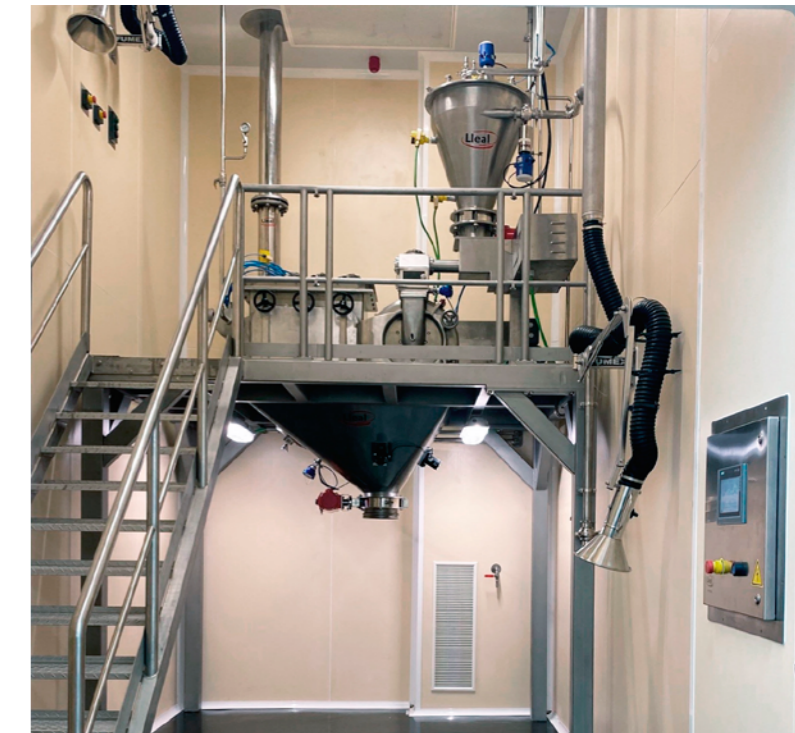
Installation de broyage K-315-MO, préparée pour travailler en zone Atex. L'équipement est alimenté par un système de transport pneumatique TS-VAC 50.
