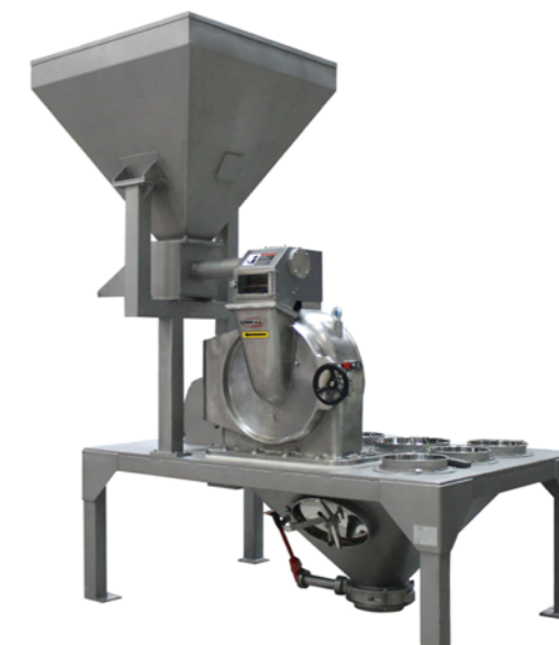
Installation de broyeur K-500-B, avec alimentateur à vis TK équipé d'une trémie spéciale de 600 L. Décharge par vanne papillon à actionnement manuel.
