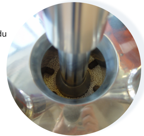
Vue détaillée de l'intérieur du panier de mouture chargée de billes de zirconium.
