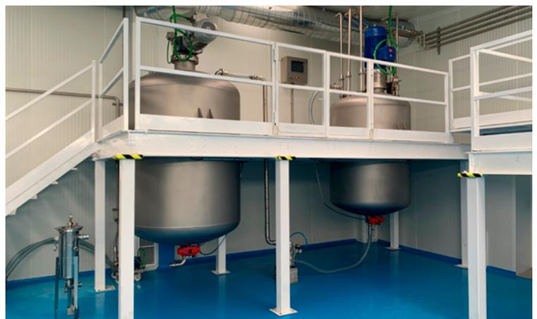
Installation pour la fabrication de gels hydroalcooliques : réacteur de 2 000 L pour la fabrication et réservoir de réglage de formulation 2 500 L.
