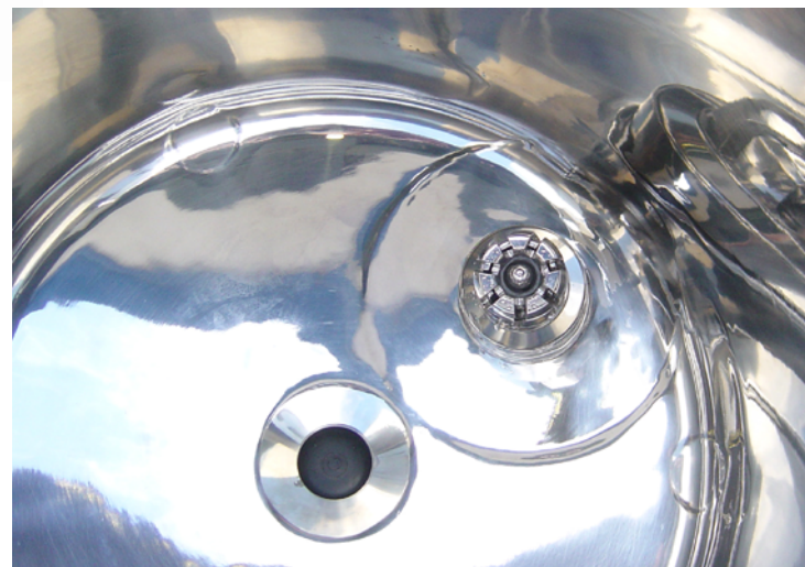
Détail de la turbine magnétique.
