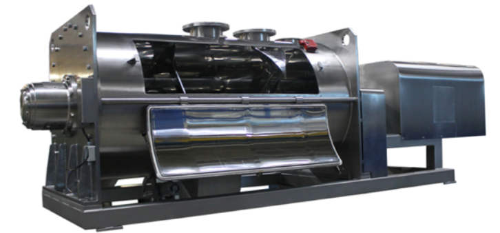
Mélangeur intensif MIR-2.000. Trappe latérale pour faciliter le nettoyage à l'intérieur du mélangeur et accélérer le changement de produits entre les productions.
