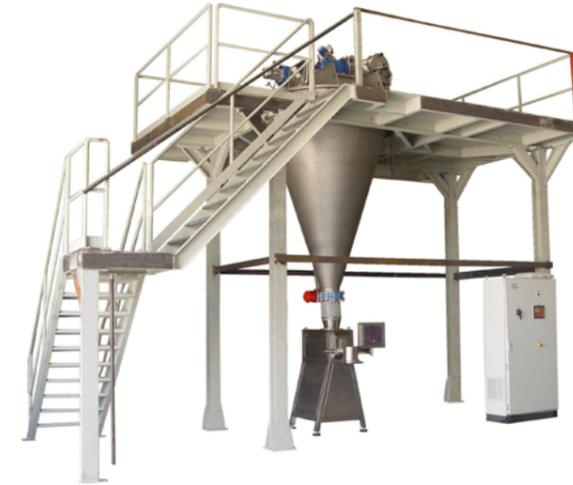
Mélangeur C-1000 monté sur structure, alimenté par un tamiseur centrifuge CEN-450 et couplé à une ensacheuse S-50-T pour le déchargement.
