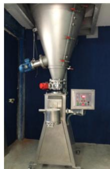
Mélangeur C-500 avec intensificateur monté sur le côté inférieur. Il dispose d'une vanne latérale pour faciliter le nettoyage.
