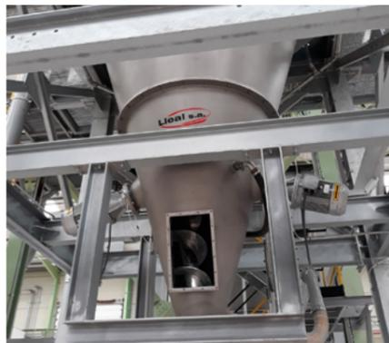
Mélangeur conique équipé de deux intensificateurs type cutter.
