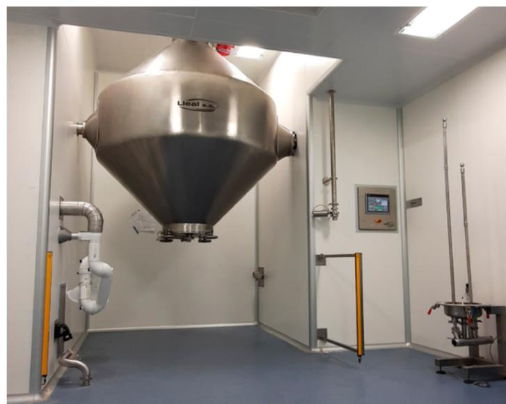
Mélangeur biconique BC-4200, conçu pour la fabrication de produits pharmaceutiques et installé en salle blanche.
