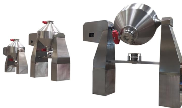
Vue de trois mélangeurs biconiques modèles BC-1000 et BC-600, avec vannes pneumatiques montées sur les deux bouches du mélangeur et soufflet extensible pour le déchargement du produit.
