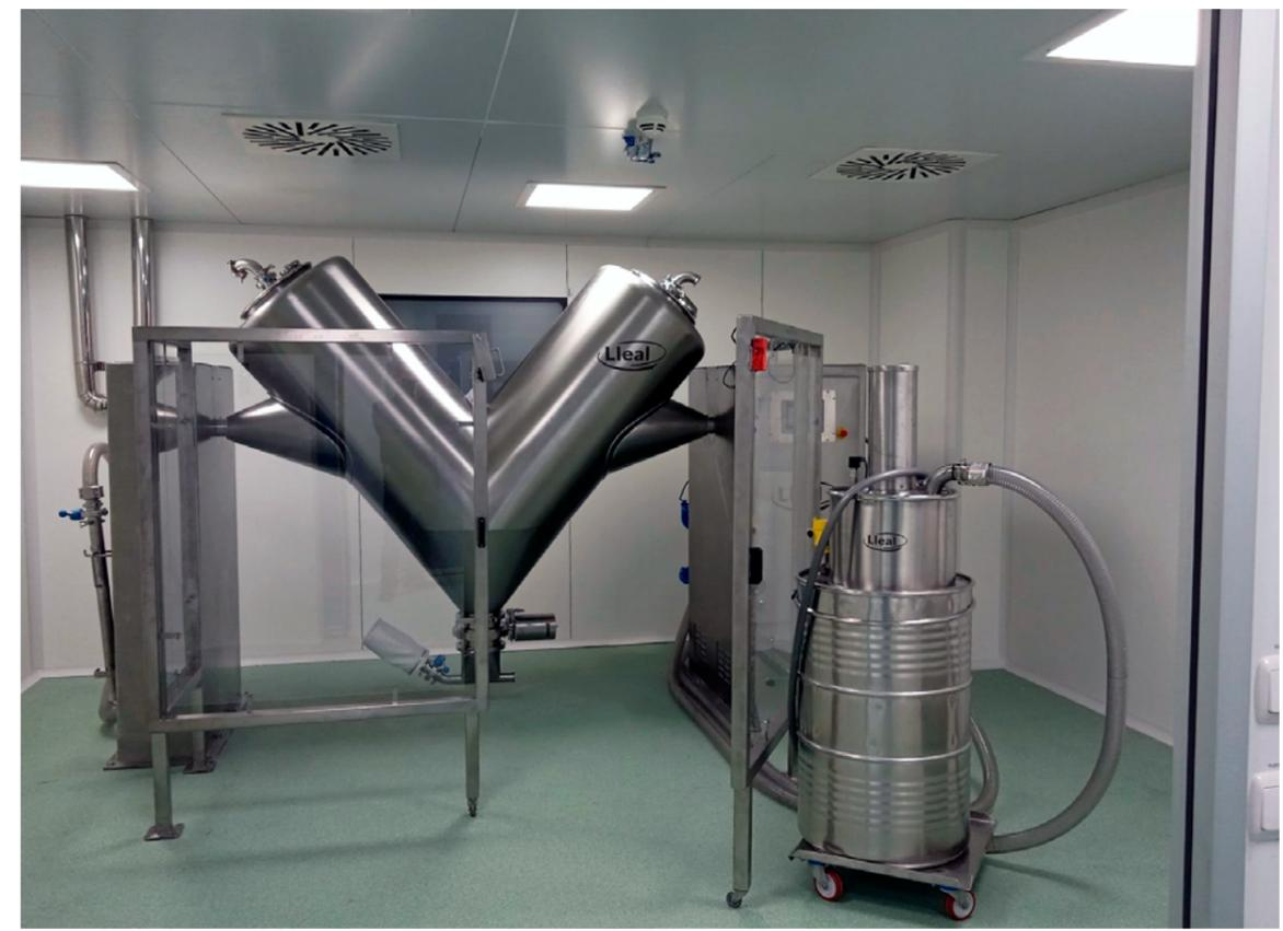
Mélangeur en V modèle B-1000, équipé d'un système de chargement et déchargement du produit dans des bidons sous vide. Équipement monté autour de la cloison de sécurité, avec des portes en polycarbonate. Mélangeur destiné à la fabrication de produits pharmaceutiques.
