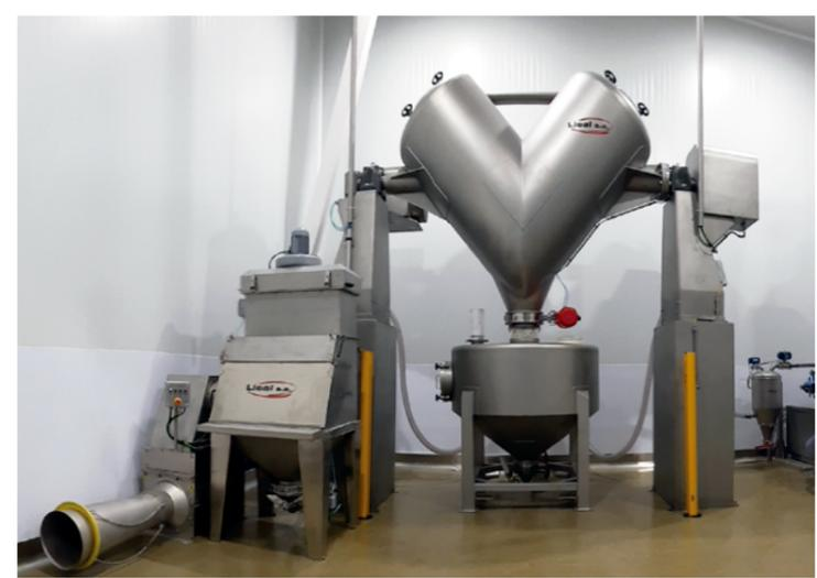
Installation de mélange composée d'un mélangeur B-3300-CA, effectuant le déchargement en conteneur de 2 000 L. L'installation comprend une trémie pour le déchargement de sacs équipée d'un système pour casser les grumeaux de produit et d'un compacteur de sacs vides. La charge dans le mélangeur s'effectue sous vide.
