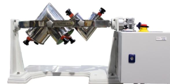
UVE MIX monté avec un corps de 3 L et un corps de 1 L.
