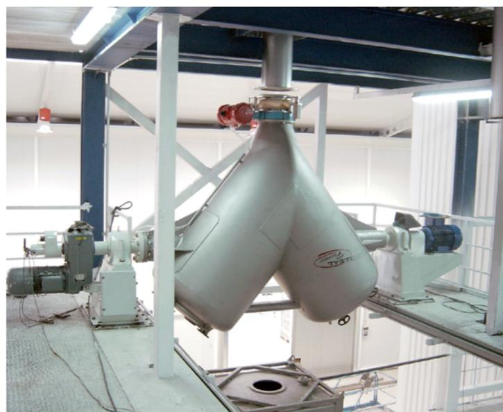
Vue d'un mélangeur en position de charge automatique
