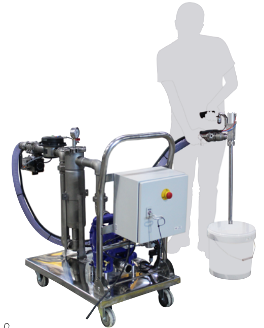
Grupo filtrante equipado con contador volumétrico y pistola de dosificación. Filtro modelo EBF0104
