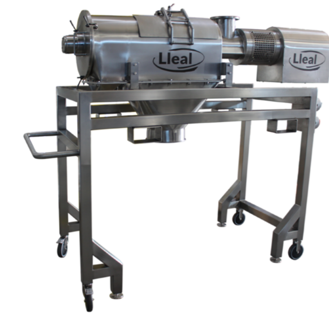
Tamizadora CEN-650 protección Atex construida totalmente en acero inoxidable AISI-316
