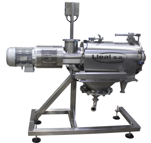
Tamizadora CEN-450 montada sobre bancada móvil. La tapa delantera es de fácil apertura mediante guía de giro a 180° para facilitar el acceso al interior en las tareas de limpieza y mantenimiento.
