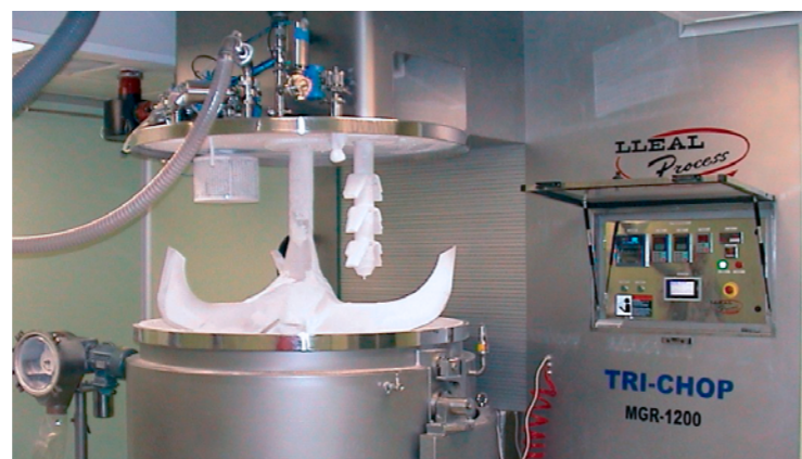
Vista de un TRI-CHOP MGR-1200 con bancada panelable, instalado en sala blanca de empresa farmacéutica
