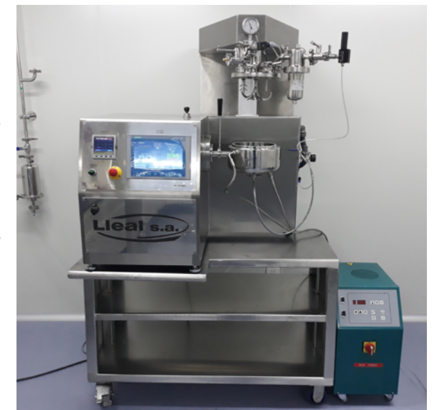
Granulador TRI-CHOP MGR-1 instalado en sala blanca
