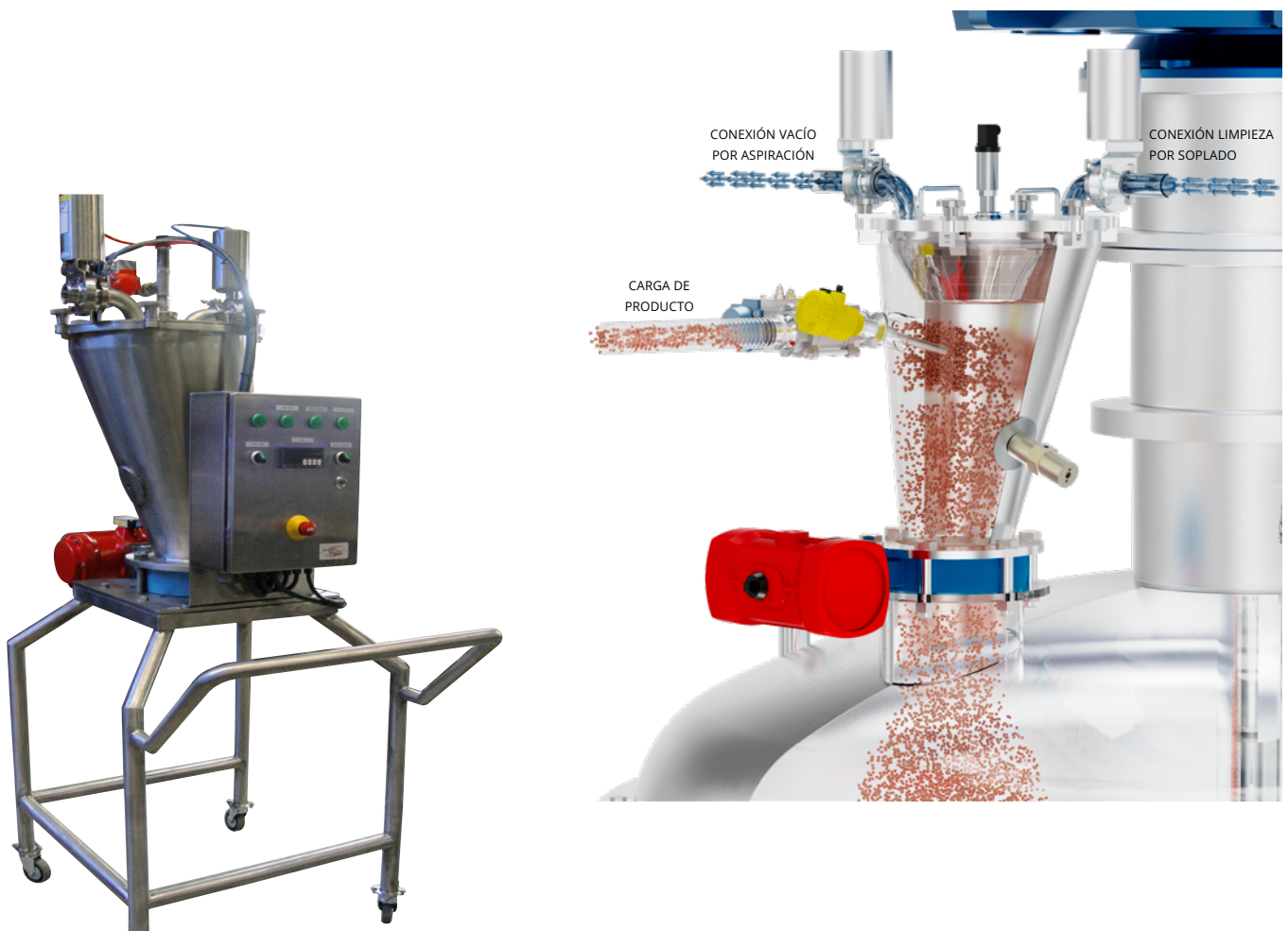
Transporte neumático TS-VAC montado sobre una estructura móvil de acero inoxidable.
