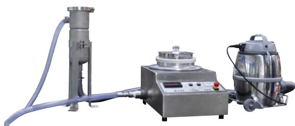
Tamizadora MICRA 200 conectada a un filtro de 1 m<sup>2</sup> con carcasa de acero inox. y a un aspirador de 1200 W.
