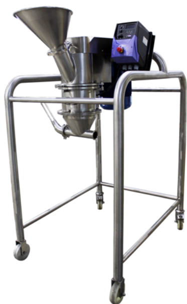
Tamizadora cónica TGC/LL-220 móvil, con boca de descarga del producto preparada para acoplar transporte neumático.
