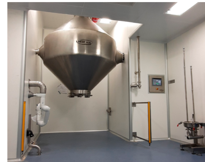
Secador SBC-4200 en sala limpia.
