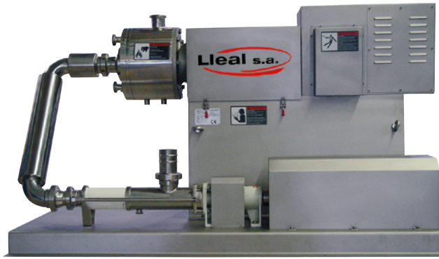
Molino coloidal MCH-6 en acero inox. AISI-316, alimentado por bomba helicoidal Sanitaria Salomón, conectada mediante tubería calefactada.
