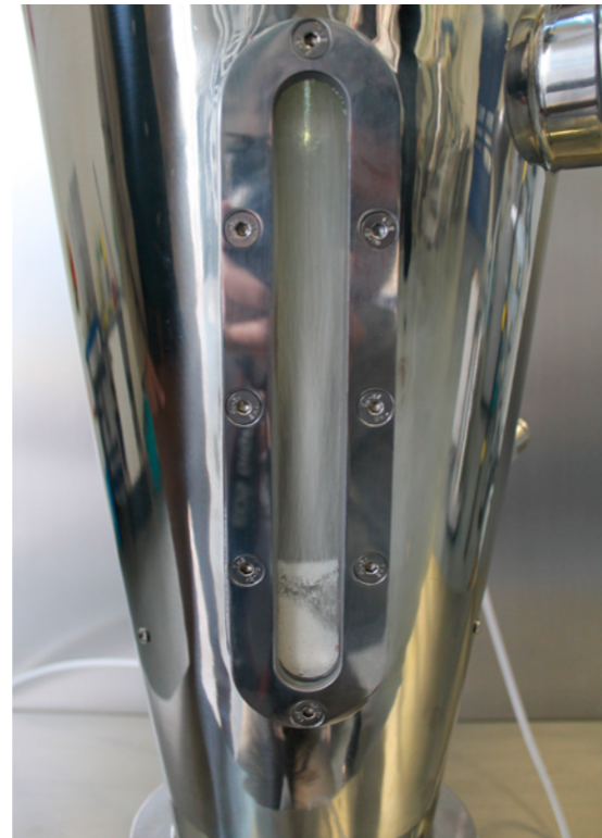
Detalle de la tolva de producto. Desde la mirilla es visible el producto en fluidificación
