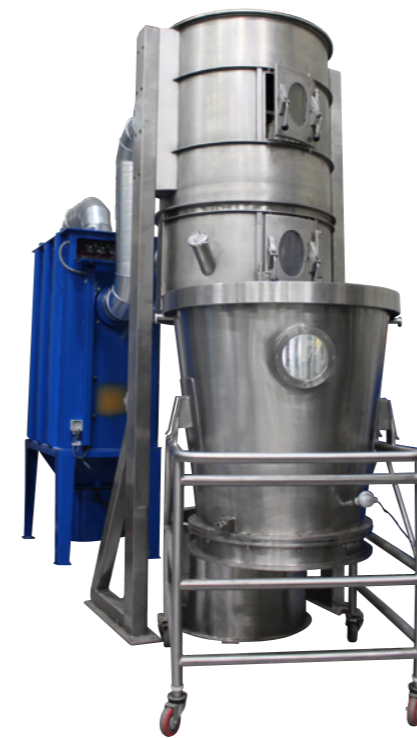
Secador de lecho fluido SLF/LL-100, conectado a filtro de seguridad de láminas sinterizadas.
