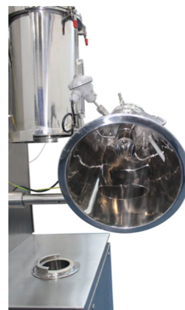
Detalle del tubo Wurster instalado en la tolva de producto, en posición de descarga
