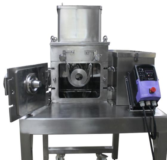
Vista del interior de una granuladora MG.
