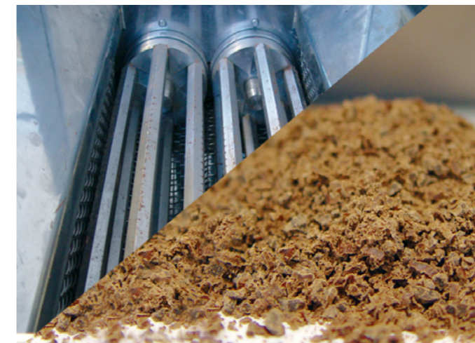
Detalle de los rodillos granuladores de una CT-400 con malla en la parte inferior y detalle del producto resultante.
