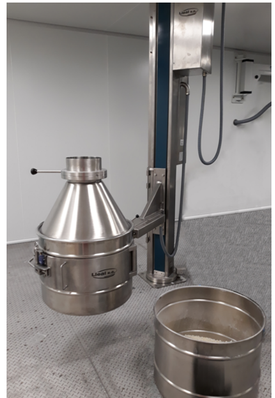
Elevador de columnas ECLL-200 para BINS con sistema de elevación por cadena, preparado para una carga máxima de 200 kg
