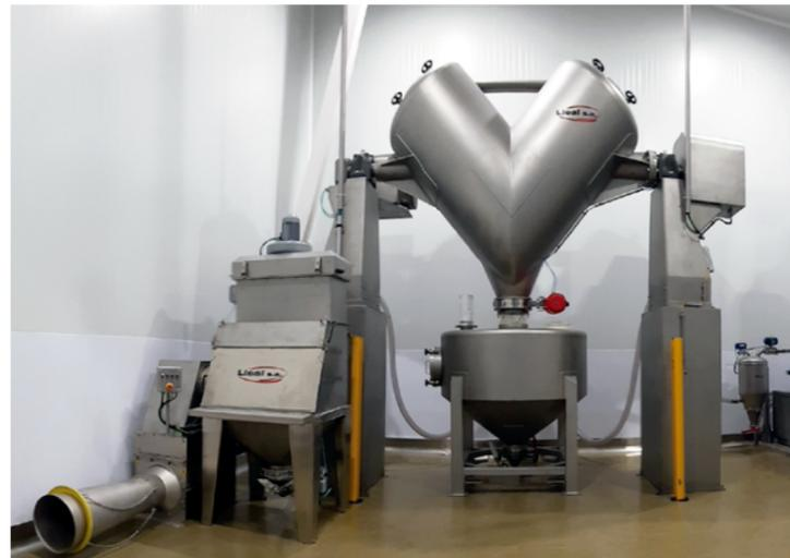
Instalación de mezcla compuesta por un mezclador B-3300-CA, efectuando la descarga en contenedor de 2.000 L. La instalación incluye una tolva para la descarga de sacos equipada de un sistema para romper los grumos de producto y un compactador de sacos vacíos. La carga en el mezclador se efectúa mediante vacío.
