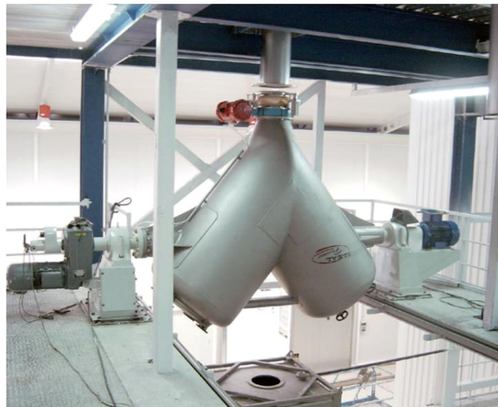
Vista de un mezclador en posición de carga automática
