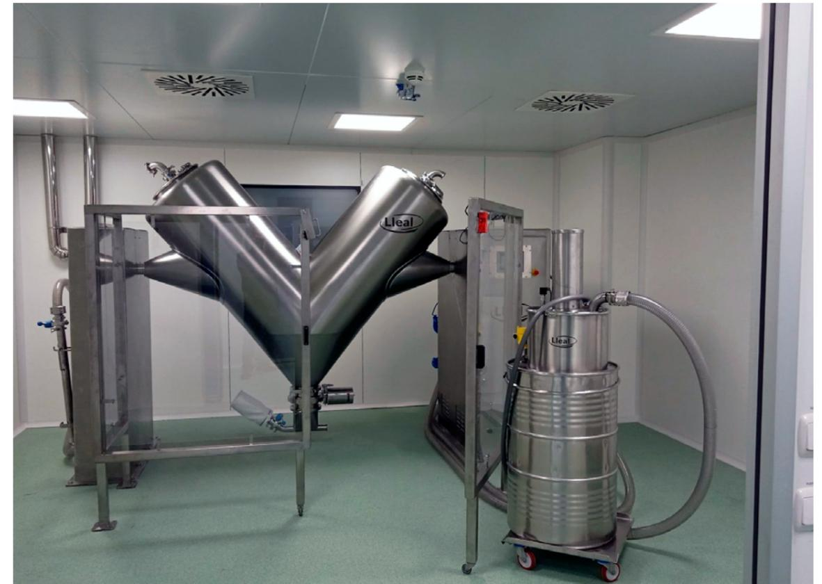
Mezclador en V modelo B-1000, equipado con sistema de carga y descarga de producto en bidones mediante vacío. Equipo montado alrededor de mampara de seguridad, con puertas de policarbonato. Mezclador destinado a la fabricación de producto farmacéutico.
