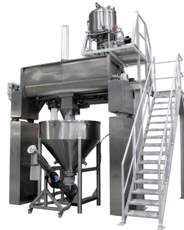
Instalación de mezcla compuesta por caldera fusora en la parte superior que descarga jarabe caliente sobre mezclador de bandas MB-700. Equipo destinado al sector de la alimentación.
