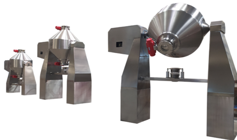
Vista de tres mezcladores bicónicos modelos BC-1000 Y BC-600, con válvulas neumáticas montadas en las dos bocas del mezclador y fuelle extensible para la descarga del producto.
