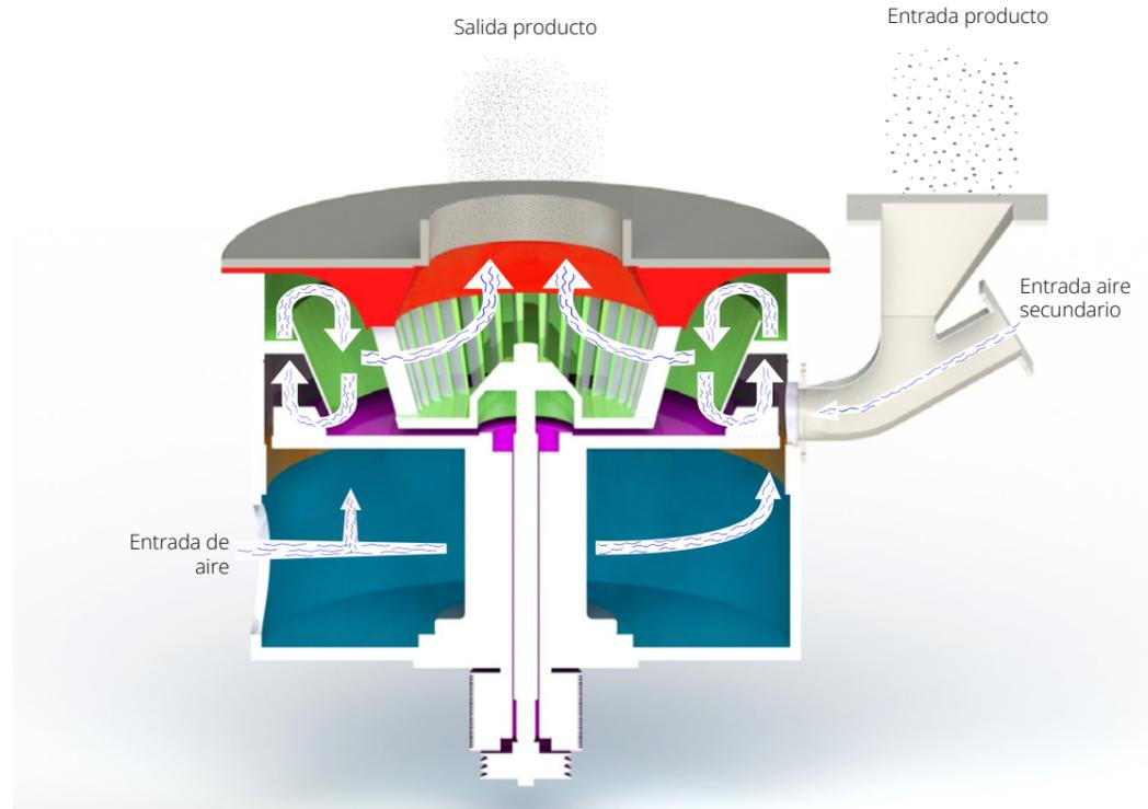
Diagrama de funcionamiento del molino
