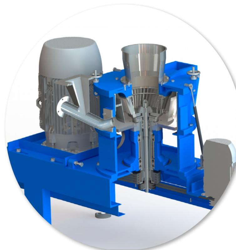
El disco de molienda puede ser equipado con diferentes elementos obteniendo un efecto de impacto, corte o fricción. La regulación del tamaño de salida se logra mediante el ajuste de la velocidad del clasificador y el caudal de aire procesado por el molino.
