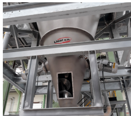
Mezclador cónico equipado con dos intensificadores tipo cúter
