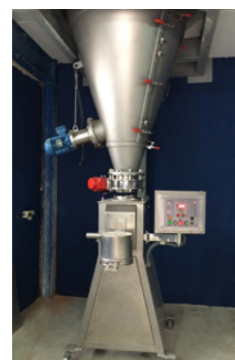
Mezclador C-500 con intensificador montado en el lateral inferior. Dispone de una compuerta lateral para facilitar limpieza.
