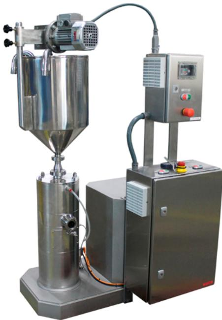
El triple etapa MHE es un emulsionador en línea, diseñado para su montaje entre tuberías. Este equipo puede servir como complemento al TRI-AGI así como a REACTORES O DILUIDORES. Es la máquina ideal para:
