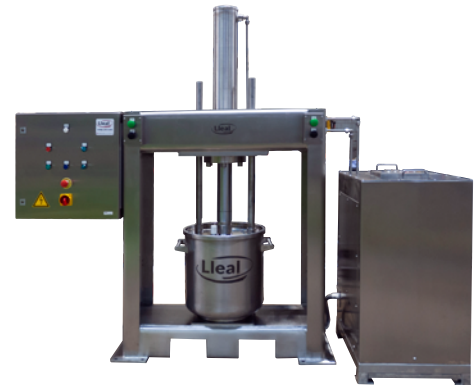
Prensa hidráulica PH-45, destinada al vaciado de bidones con ingredientes farmacéuticos activos.
