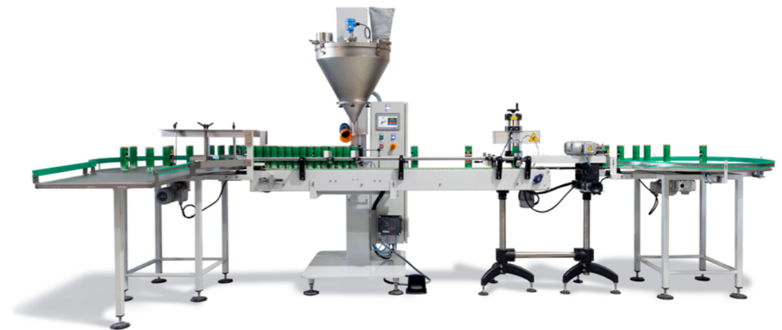
Línea de envasado de polvo en botes, en dinámico y con control de dosificación por volumen, instalada con mesa giratoria de entrada de envases y mesa de recogida al final de la línea.
