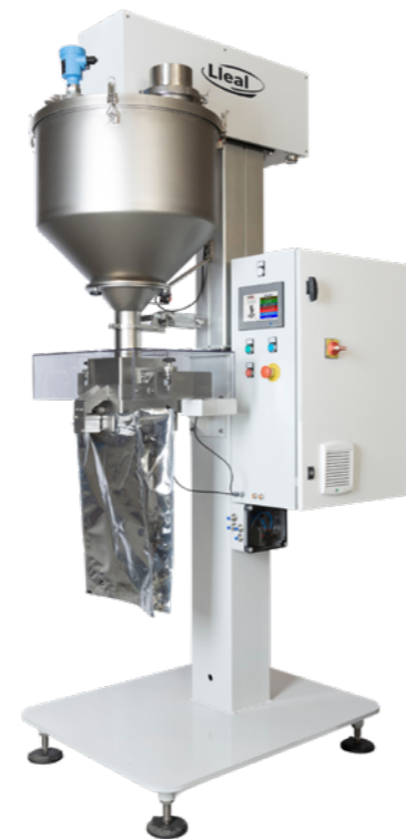
Envasadora para el llenado de polvo en bolsas pre confeccionadas desde 300 hasta 5.000 gramos. Altura regulable para adaptarse al envase.
