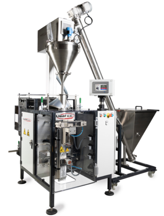
Envasadora vertical EVLL-160 alimentada por un dosificador DPLL-1/5 y una rosca transportadora.
