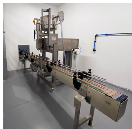
Envasadora volumétrica PR-5000 con cinta transportadora para envases, de 3 metros de longitud y con roscador neumático.
