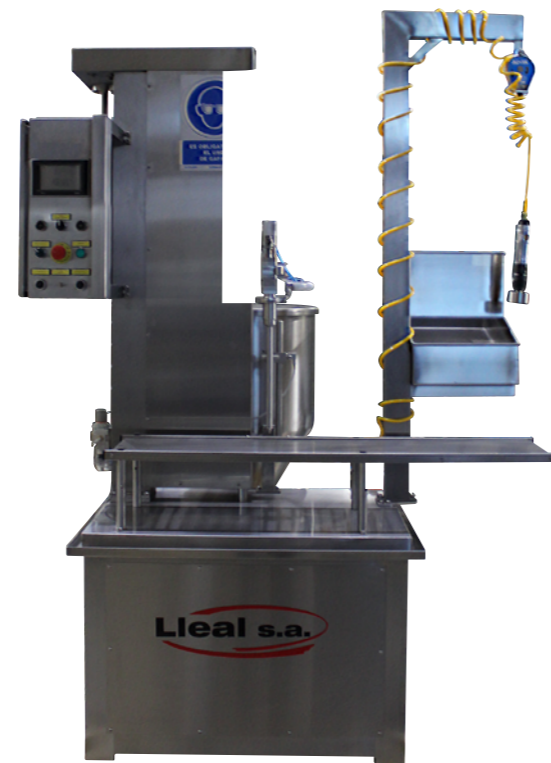
Invasadora semiautomática STAR con regulación de parámetros mediante pantalla táctil
