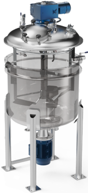
Reactor DÚPLEX con agitación lenta tipo áncora y turbina inferior
