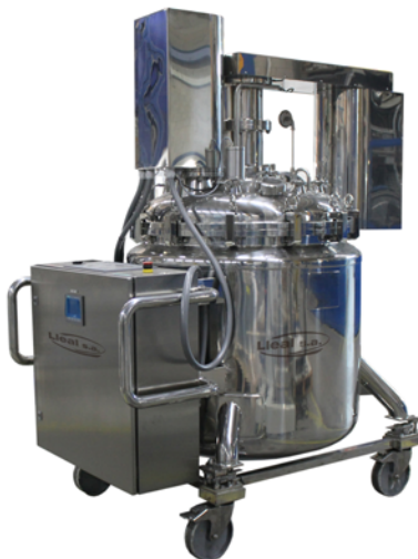
Reactor de 400 L con doble agitación, preparado para trabajar con presión interior
