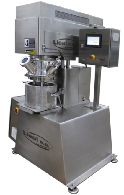
Plamixer de laboratorio PLD-15 construida íntegramente en acero inoxidable
