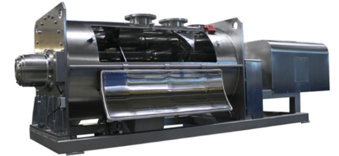
Mezclador intensivo MIR-2.000. Compuerta lateral para facilitar la limpieza en el interior agilizando el cambio de productos entre fabricaciones.
