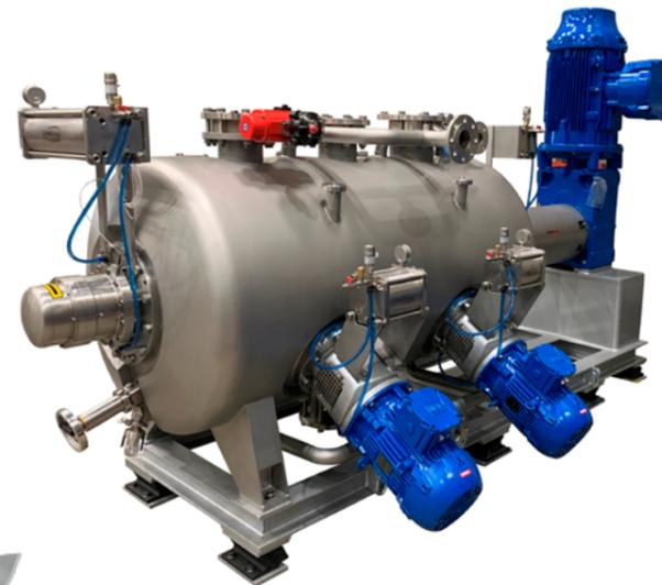
Reactor Intensivo modelo RMIR-1200-TAI fabricado en acero inoxidable AISI-316L. Está preparado para trabajar con presión y vacío y dispone de doble camisa de calefacción.
